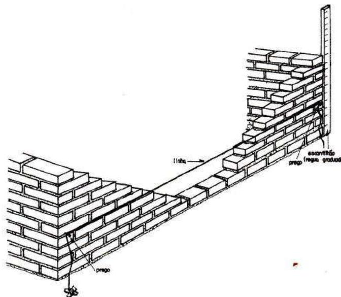
**Figura 5 - Detalhe do nivelamento da elevação da parede.**
