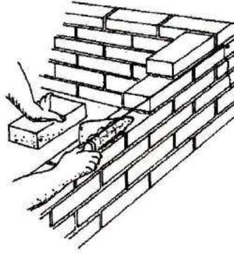
**Figura 7 - Colocação da argamassa de assentamento**
