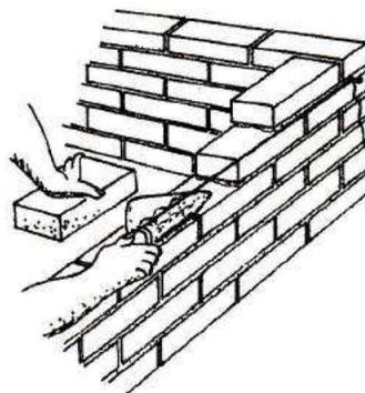
**Figura 4 - Colocação da argamassa de assentamento**
