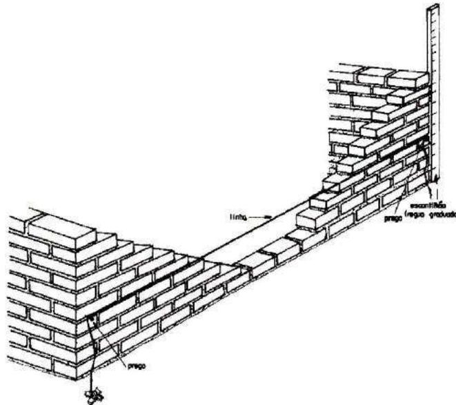
Figura 5 - Detalhe do nivelamento da elevação da parede.
