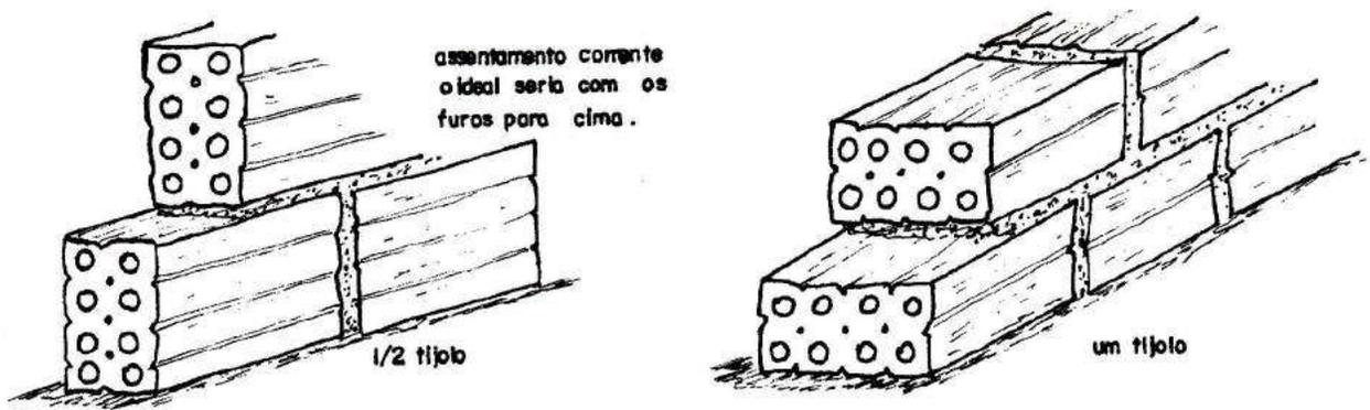
Figura 1 - Execução de alvenaria utilizando tijolos furados.
