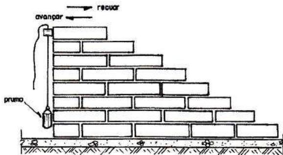
**Figura 3 - Detalhe do prumo das alvenarias.**
