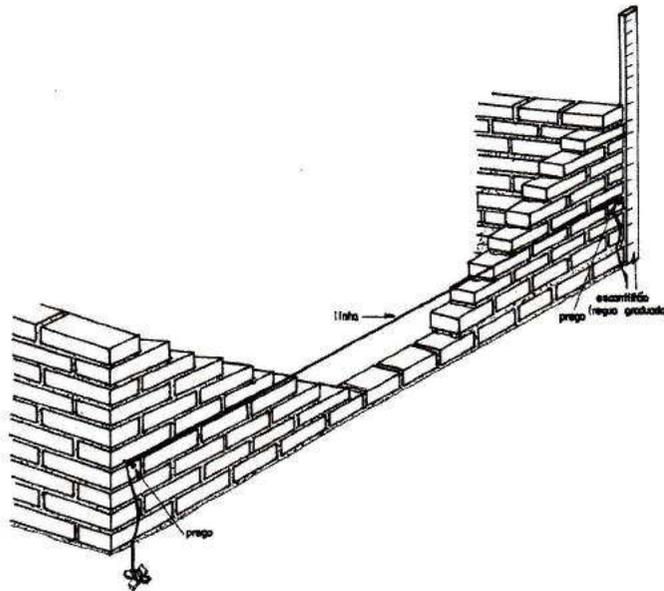
**Figura 2 - Detalhe do nivelamento da elevação da parede.**
